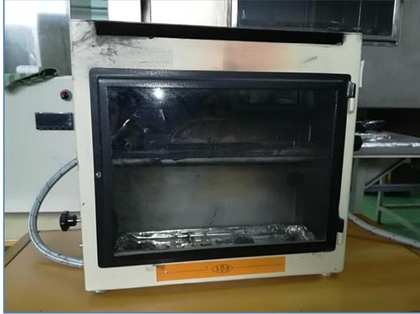
*Figura 4. Cámara de ensayo inflamabilidad horizontal*
