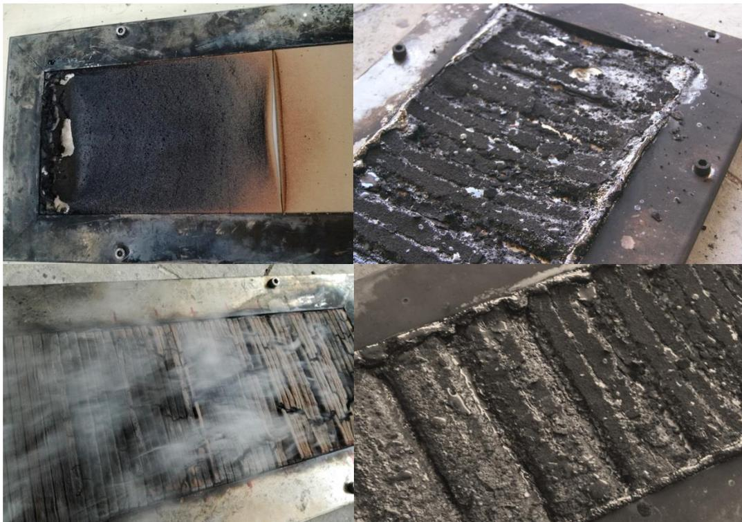
Figura 8. Muestras tras ensayo de panel radiante (de izquierda a derecha y de arriba abajo: WPF06-Baldosa-03, WPF05-Baldosa-02, WPF02-Baldosa-01, WPF07-Baldosa-04)
