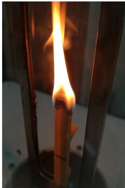
*Figura 3. Muestra de WPC durante el ensayo LOI*
