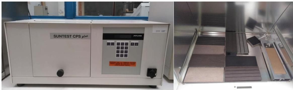
*Figura 11. Equipo Suntest CPS + de ATLAS. Ejemplo de muestras de WPC ensayadas en el interior del equipo.*
