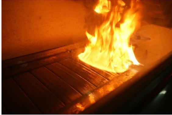
*Figura 6. Muestra de WPC durante el ensayo del panel radiante*
