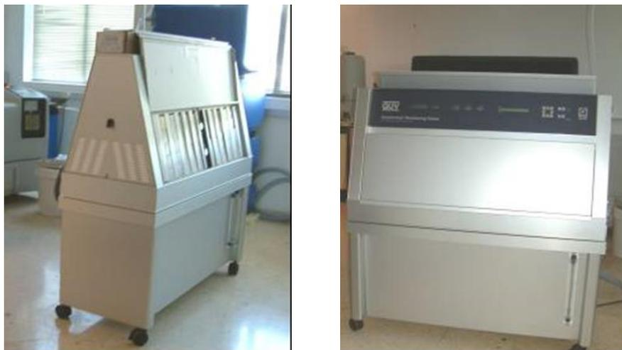
*Figura 13. Equipo de envejecimiento artificial con lámparas UV, QUV.*
