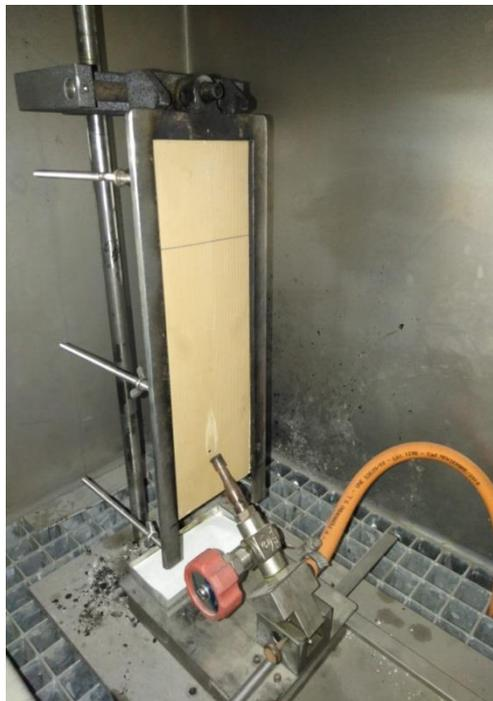
*Figura 5. Muestra de WPC durante el ensayo del pequeño quemador*
