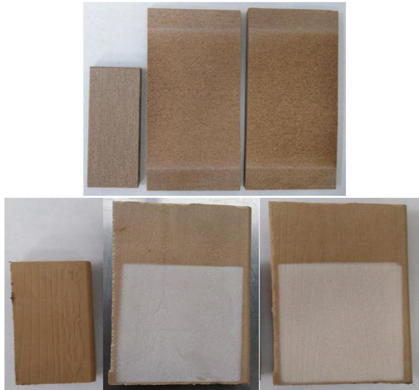
Figura 16. Muestras **WPF\_06** y **WPF\_07** tras ensayo de **envejecimiento artificial en QUV**. De izquierda a derecha: probeta de control, probeta tras 504 horas de exposición, probeta tras 1008 horas de exposición.
